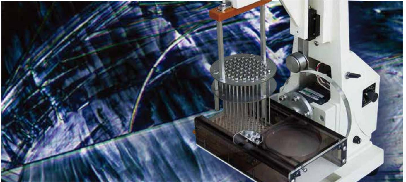
本製品は一度に多くの試料を正確かつ均一にシャーレに移植でき、再現性に優れた信頼度の高い測定が行えます。MIC判定、抗生物質の開発、菌の耐抗性テストなど様々な検査にご活用いただけます。
